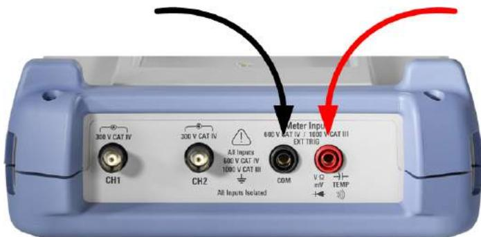
图 4-1: 连接测试引线到万用表输入端
