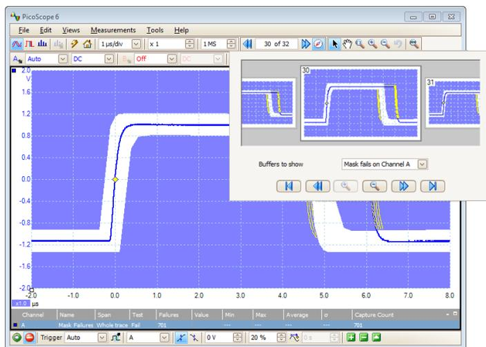
数值与图形容限编辑器可单独使用也可结合使用，让您能够输入准确的容限规定、修改现有容限以及将容限导入导出为文件。
