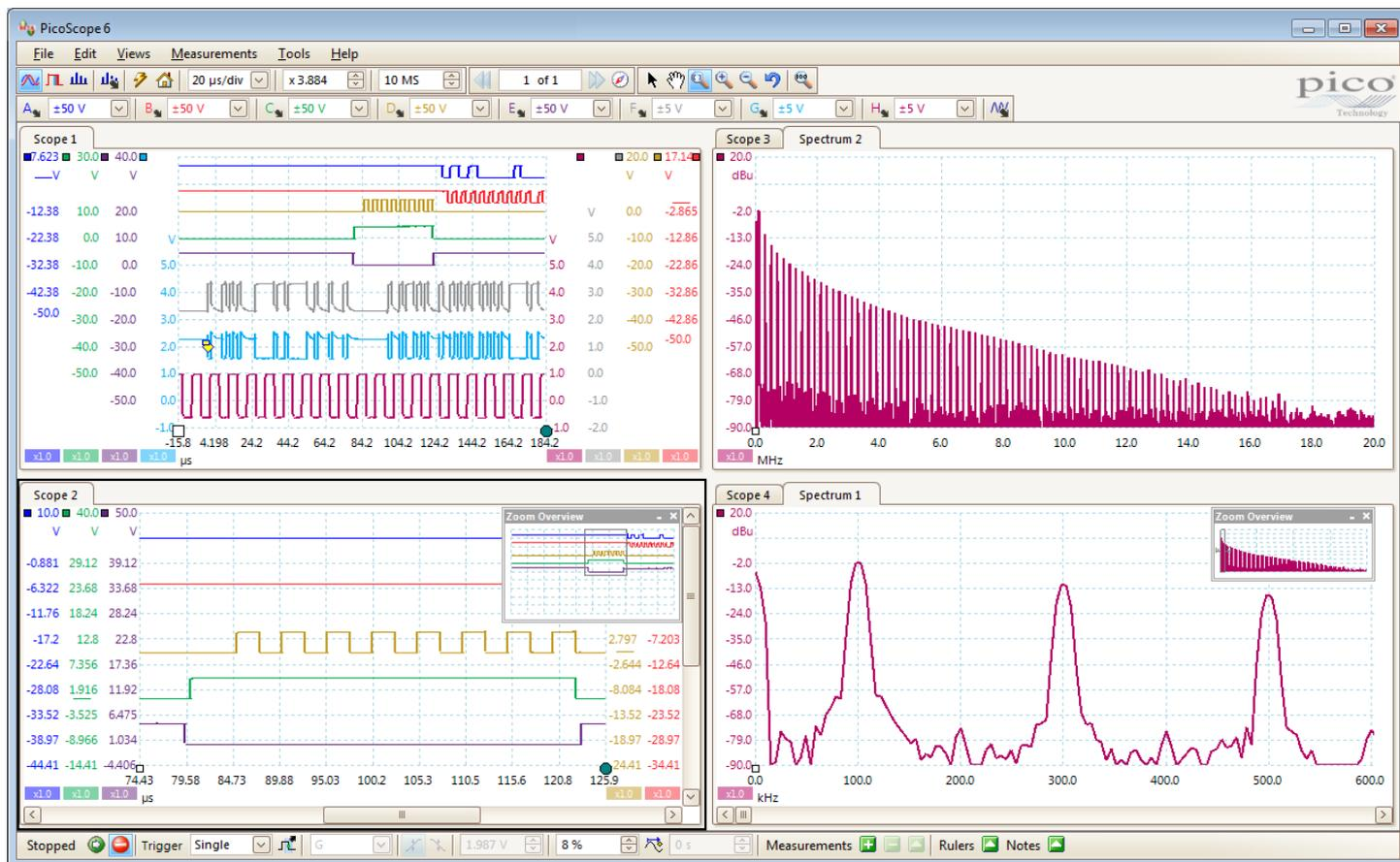
可自定义屏幕切分，以展示所需波形的任一组合，显示出同一信号的多个通道或不同变量。如上例所示，软件甚至还一次性同时显示出示波器和频谱分析仪的轨迹。此外，还可分别对显示出的每个波形进行缩放、平移和过滤设置，以实现最高灵活性。
