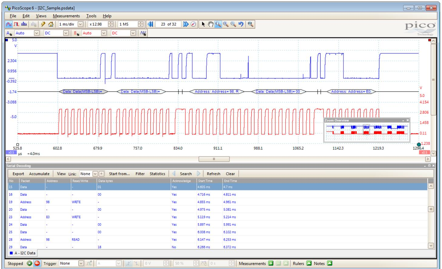
PicoScope 4824 的标配为所有 8 个通道上都具有串行解码功能。解码的数据可以您选择的格式显示：**视图**、**窗口**中，或同时显示在视图和窗口中。
