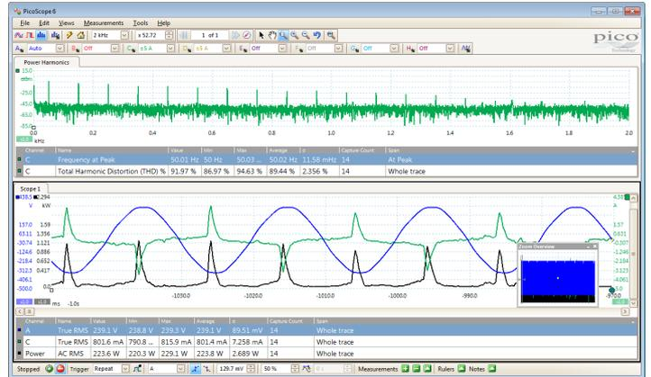
PicoScope 4824 适用于在高电压和电流及低电压控制信号上执行各种功率测量。为获得最佳结果，请将 Pico 差分电压探头 (TA041 或 TA057) 与电流钳 (TA167) 组合使用。为提高功率设计的效率和可靠性，示波器可显示并分析待机功率耗散、冲击电流和稳态功耗。使用 PicoScope 内置的参数 (如真实 RMS、频率、峰间电压和 THD) 测量和统计功能，可对电能质量进行准确分析。
