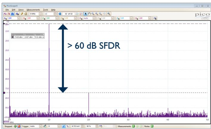
可将一系列自动频域测量值(包括 THD、THD+N、SINAD、SNR 和 IMD)添加到显示器。您甚至可以一起使用 AWG 和频谱模式来执行扫描标量网络分析。
