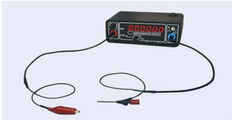
图 5：带发生器电缆的 SGZ 21，外加一个鳄鱼夹和一个微型探针
