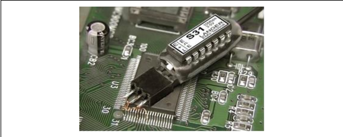
图 9：例如，在被测装置中，S31 传感器通过一个三极插座连接到集成电路中。
