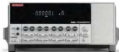
5 1/2 位 6485 型皮安表可以测量 20fA 至 20mA 的电流, 速度高达每秒 1000 个读数。6487 型皮安表 / 电压提供比 6485 具有更高的精度和更快的上升时间、配备 500V 电压源以及提供与电容设备配合使用的阻尼功能。
