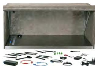
比较测量元件组和设备的干扰放射。为了顺利且易理解的排除干扰, 该系统包含了一套根据研发工程师工作定制的 CS-ESA 软件。特别适合研发人员在工作现场测试。在开发过程中, 用 ESA1 系统进行干扰放射的测量结果与远场测量或用模拟电路网络的测量结果成正比。使用 ESA1 系统中的各种工具可定位干扰源, 发现干扰放射的耦合或传输途径, 这样可找到合理的电磁兼容性方案, 并确定其大小。使用 ESA1 系统得到的电磁兼容改进效果成正比符合板远场测量效果。
