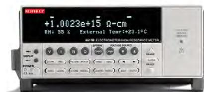
可实现精确的高阻抗和低电流测量。5 1/2 位 6514 型和 6517B 型静电计提供 1fA 灵敏度, 输入阻抗 >200TΩ 的电压测量, 以及低至 10fC 的电荷测量。其中 6517 内置的 ±1kV 电压源, 具有扫描的功能, 简化了漏电、击穿和电阻测试, 配合夹具盒可以进行绝缘材料的体电阻 (Ω - cm) 和表面电阻率 (Ω/square) 的测量。
