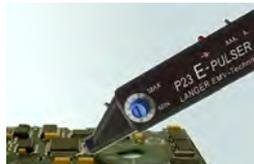
产生的干扰电场脉冲,通过发生器的顶端注入到被测集成电路的数字输入端口,如复位、时钟、晶振、或者相应信号线的引脚。产生的最大电压为 1.2kV。
