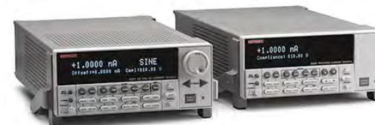
6220/6221 型直流电流源将易用性与极低的电流噪声相结合。在测试环境中, 从研发到生产, 尤其是在半导体、纳米技术和超导体行业, 低电流源对于应用至关重要。6220 具有高精度源和内置控制功能, 非常适合使用增量模式、脉冲测量和微分电导测量的霍尔测量、电阻测量等应用。其中 6221 可生成高达 100kHz 的平滑正弦波。6220/6221 与 2182A 型纳伏表配合使用时支持低至 50 μs 的脉冲式 I-V 测量。
