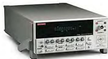
双通道 2182A 型纳伏表最适合进行稳定的低噪声电压测量, 以及适合可靠且重复地检定低阻材料和器件。相比其他低电压测量解决方案, 其测量速度更快, 噪声性能显著提高。它提供简化的增量模式, 适用于结合反向电流源 (如 6220 或 6221 型号) 进行电阻测量。
