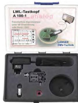
把在 EFT/ESD/ 高频干扰影响下的模拟信号显示到示波器上。在检测电力或电子设备对高频电磁场 (IEC 61000-4-3 到 IEC61000-4-6) 的抗干扰性时,该系统特别适合于检测模拟信号。对电磁场进行给定的调制时会对模拟信号产生影响, A100、A200 和 A300 系列模拟信号干扰传输器能够快速识别到这些影响。内含一个传感器,测量被测物中的模拟信号,并把测得的模拟信号转为光信号;光信号通过光纤传到光接收器,接收器再把光信号转化为电子模拟信号,进而传到示波器。示波器可显示这些信号,或用它们来控制其它设备。
