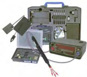
一套 PCB 板开发过程中进行抗干扰分析的 EMC 测试工具系统,能够快速精准地定位脉冲干扰和静电放电干扰的原因 (PCB 板中的薄弱点),使开发人员能够准确针对薄弱点设计恰当的 EMC 措施,并且可使用 E1 来评估 EMC 措施的效果。E1 系统搭建空间小,适宜于在 PCB 板开发人员的工作现场使用。通过它可了解 EMC 工作机制以及 PCB 板去干扰的基本测量策略。E1 系统包括一个脉冲群干扰和静电放电干扰发生器、九种不同的电场和磁场源,以及其它各类附件。
