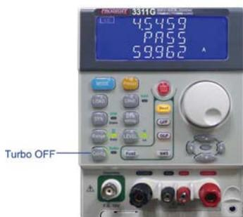
3311G Turbo mode OFF Short 測試結果畫面
