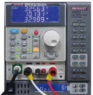
博計電子開發的Model 9923 負載電流波形產生器是提供電池放電測試的實際放電電流波形的模擬，可以將 Model 9923 安裝於3302G，3305G及3300G系列電子負載便可以模擬放電電流波形。
