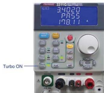
3311G Turbo mode ON Short 測試結果畫面
