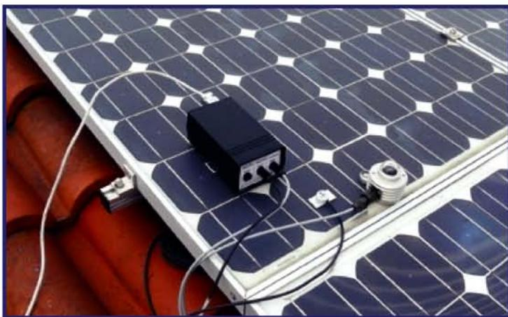
GREENTEST FTV-100附带一组通讯套件，特别适用于大型光伏系统测量时的数据实时传输。其远程控制单元可连接辐照计及PT100温度传感器，透过无线数据传输最远可达100m。
