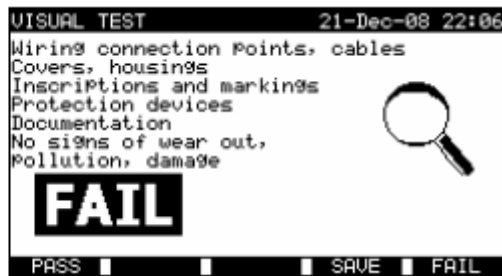
外观测试测量结果实例
