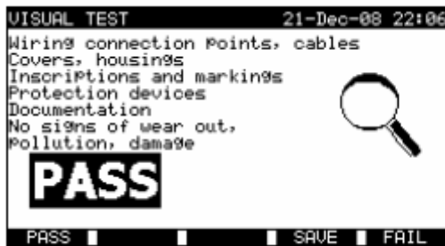
外观测试测量结果实例
