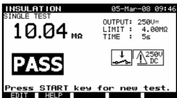
绝缘电阻测试的测试结果实例
