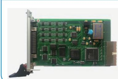
OIP32板卡是3U/4HP CPCI/PXI模拟量输出板卡，实现隔离32路模拟信号输出，以及8路隔离数字信号输出和8路隔离数字信号输入功能，对外接口采用SISC-68。OIP32板卡采用FPGA设计，可以通过更改FPGA程序实现各种定制功能，方便应用在各种仿真测控系统中。
