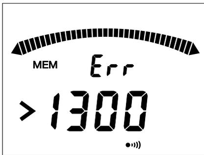
当存储器已满时 (C. A 6524 为 300 条记录, C. A 6526 为 1300 条记录)，不再能记录测量值，仪器屏幕显示如左图所示内容。
