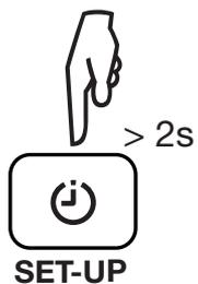
长按 SET-UP (设置) 键可进入仪器的配置 (设置) 功能。
