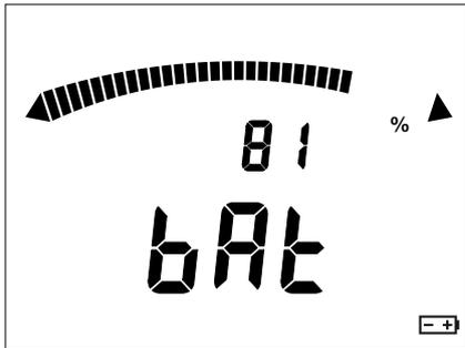
若电池电压过低，无法确保仪器的正确运行，则仪器报告电压过低。
