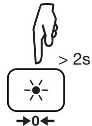
显示变为 0，且  $\rightarrow \Omega \leftarrow$  符号显示。这将从所有连续性测量值系统性减去引线的电阻。如果引线的电阻  $> 10 \Omega$ ，则无补偿。
