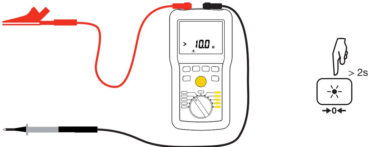
显示屏显示引线的电阻， $\rightarrow \Omega \leftarrow$  符号熄灭。
