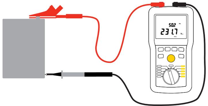
仪器显示端子上的电压。仪器检测电压是 AC（交流）还是 DC（直流），若是 AC，则显示其频率（C.A 6524 和 C.A 6526）。
