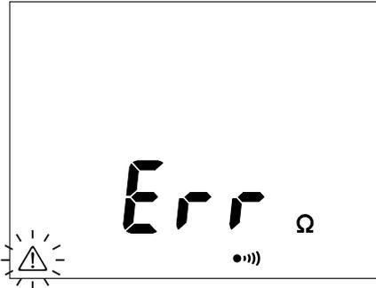
若在连续性、电阻或电容测量时仪器检测到外加电压超过 15 V（交流或直流），则仪器中断测量，屏幕显示如左图所示内容。
