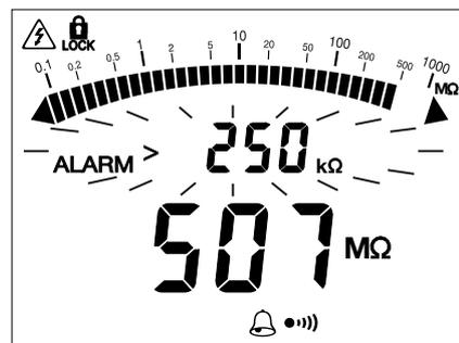
因此, 在以上示例中, 用户无需看显示单元, 仅通过听便可确定连续性测量值实际上低于 2 Ω。您可以相同方式确认绝缘质量。
