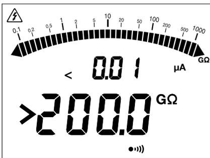
进行绝缘测量时，若待测值超出测量范围（取决于仪器和测试电压），仪器会相应报告。
