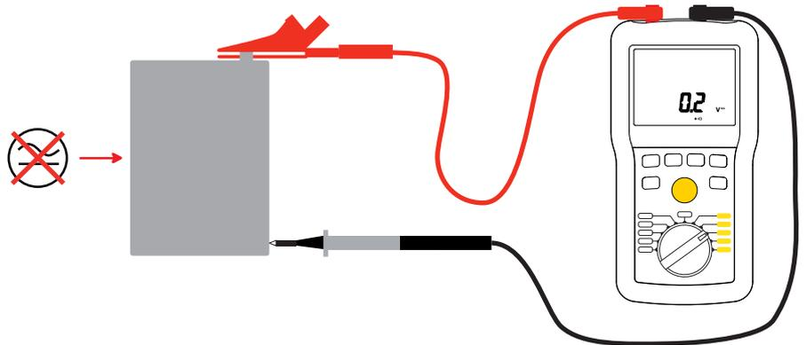
按下 **TEST** (测试) 按钮并按住，直到显示的测量值稳定为止。
