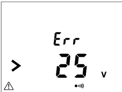
绝缘测量前，仪器处于电压测量模式。若在端子上存在超过 25 V 电压的情况下进行测量，则仪器会相应报错。
