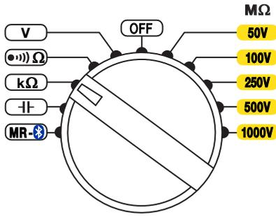
同连续性测量一样，将待测设备连接到本仪器的端子。待测设备必须处于断电状态 (见 § 2.4.3)。
