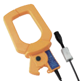
9669 钳式传感器 AC1000A, \phi 55\text{mm} , 汇流排 80 \times 20\text{mm}
