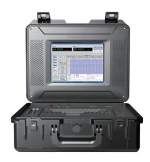
OI-915便携式压力校验系统,也为现场数字压力校验系统,由 计量测试主机、OI系列压力源和专用计量测试软件组成。其中计量 测试主机包括了专用测试计算机、嵌入式高精度数字压力校验仪、 专用电源系统及抗干扰装置。计量测试主机与压力源分别安装于防 震箱内。
