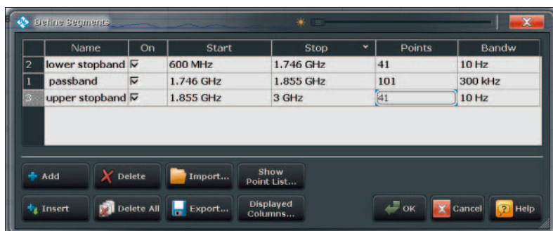
采用分段扫描的滤波器测量
