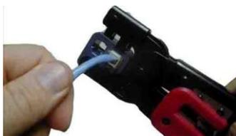
4. 使用棘轮压线钳压接连接器
