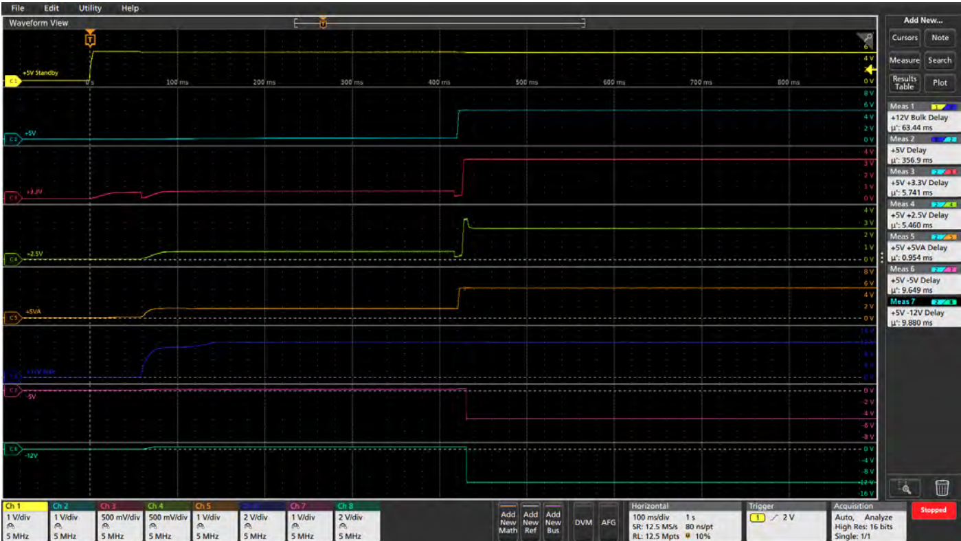
使用自动测量表征电源启动特点。
