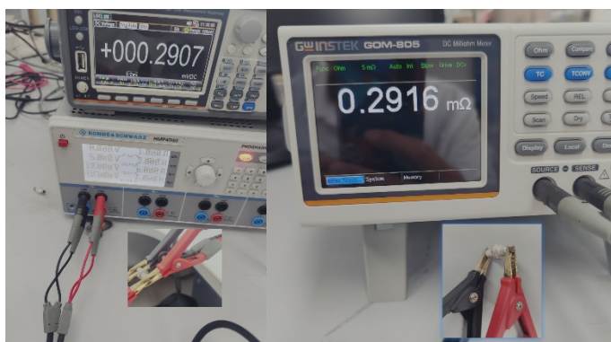
图 7 动态电流微电阻测试系统与微欧计测试结果对比
