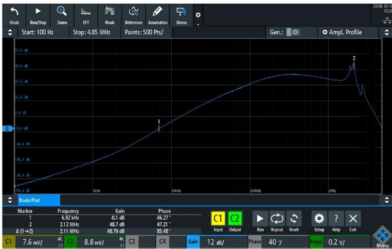
使用RTM3004示波器和J2120A线性注入器进行电源抑制比(PSRR)测量
