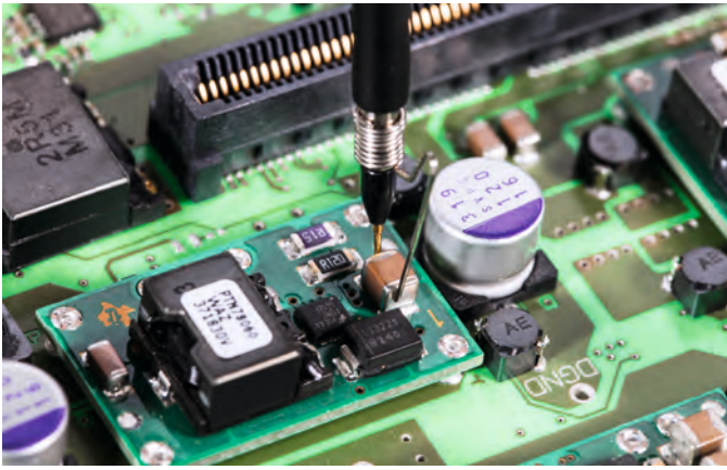
测量电源抑制比 (PSRR) 时, 使用接地弹簧, 提供最佳信噪比
