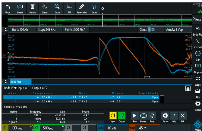
带通滤波器的频率响应（蓝色迹迹：增益；黄色迹迹：相位）
