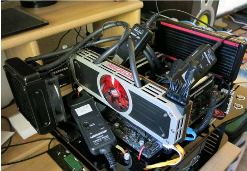
现在让我们把 [HZ050 电流探头](#) 连接到示波器 CH1 通道，并对它进行设置。接着每一步都按下面文字描述的图像操作。[显示幻灯片 1]
