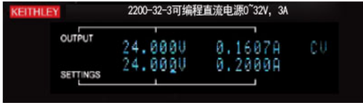
图2. 上方显示的最低有效位对应于吉时利2200系列仪器的1mV和0.1mA回读分辨率。下方显示的最低有效位对应于设置分辨率。
