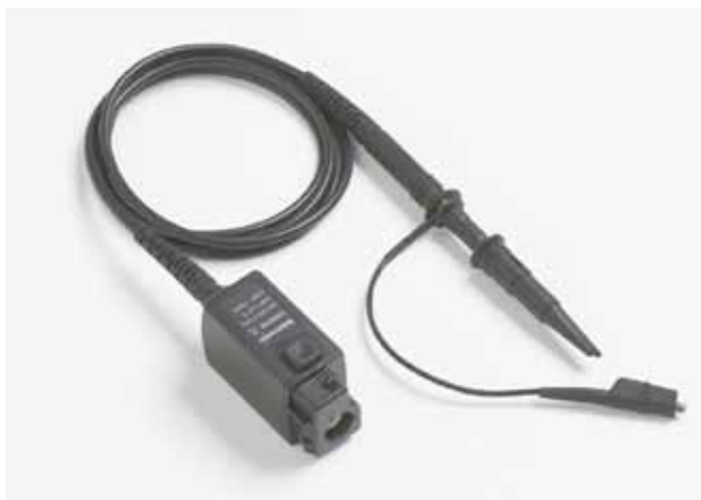
图 2. TPP0502 无源探头，500MHz 和 2x 衰减。
