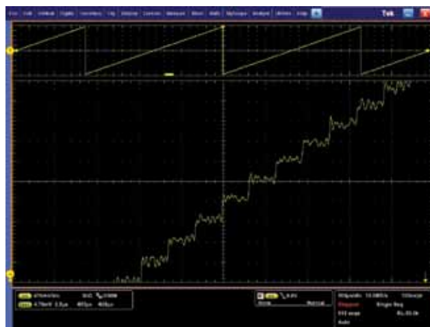
图 21. 同一高分辨率斜坡信号放大后的画面，基于大量的平均，显示垂直分辨率明显高得多。
