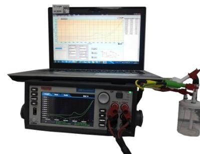
控制电压:  $\pm 5V$       电压分辨率: 200 $\mu V$
