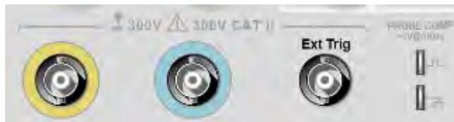
**1 & 2:** 用于显示波形的输入连接器。
