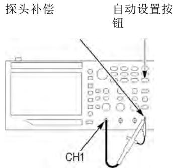
1. 按下 1 ▶ “探头” ▶ “电压” ▶ “衰减” 选项并选择 10X。将相应的 TPP0051、TPP0101 或 TPP0201 探头连接到示波器上的通道 1。如果使用探头钩式端部，请确保钩式端部牢固地插在探头上。
