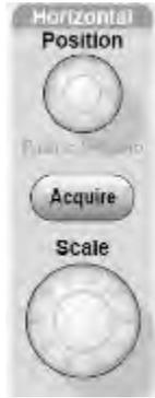
**位置：**调整所有通道和数学波形的水平位置。这一控制的分辨率随时基设置的不同而改变。
