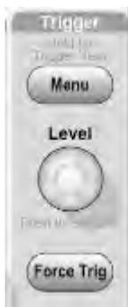
**触发菜单：**按下一次时，将显示触发菜单。按住超过 1.5 秒时，将显示触发视图，意味着将显示触发波形而不是通道波形。使用触发视图可查
