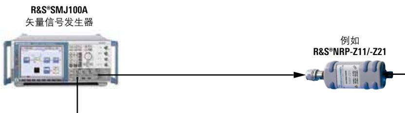
通过使用R&S®NRP-Z11/-Z21终结功率探头，完成R&S®SMJ100A 信号发生器的自动电平修正
