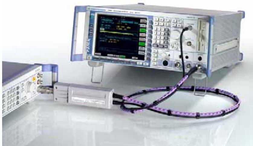
配有NRP-Z37功率探头模块的R&S®FSMR测量接收机
