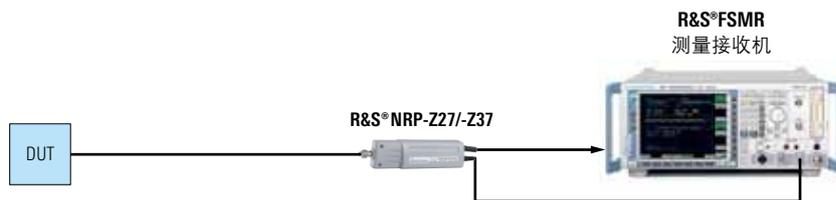
配有NRP-Z27/-Z37功率探头模块的R&S®FSMR测量接收机
