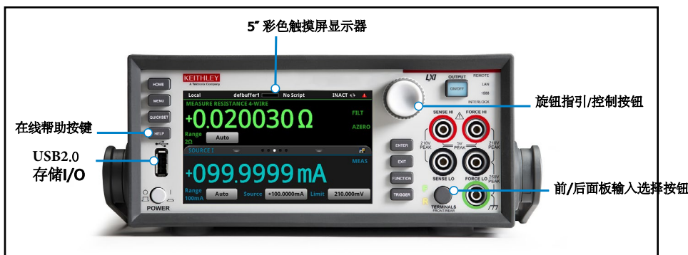
2450-OI仪器前面板，包括高分辨率电容触摸屏
