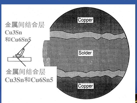
最后冷却凝固形成焊 点63Sn/37Pb焊料为
