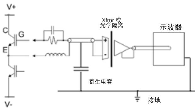
图 2.13. 进行浮动测量的探头隔离实例。
