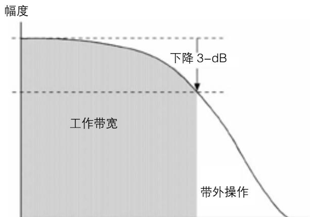
图 1.5. 探头和示波器是根据规范在工作带宽上进行测量而设计的。在超过 3 dB 点的频率上，信号幅度会变得极度衰减，测量结果可能会变得不能预测。
