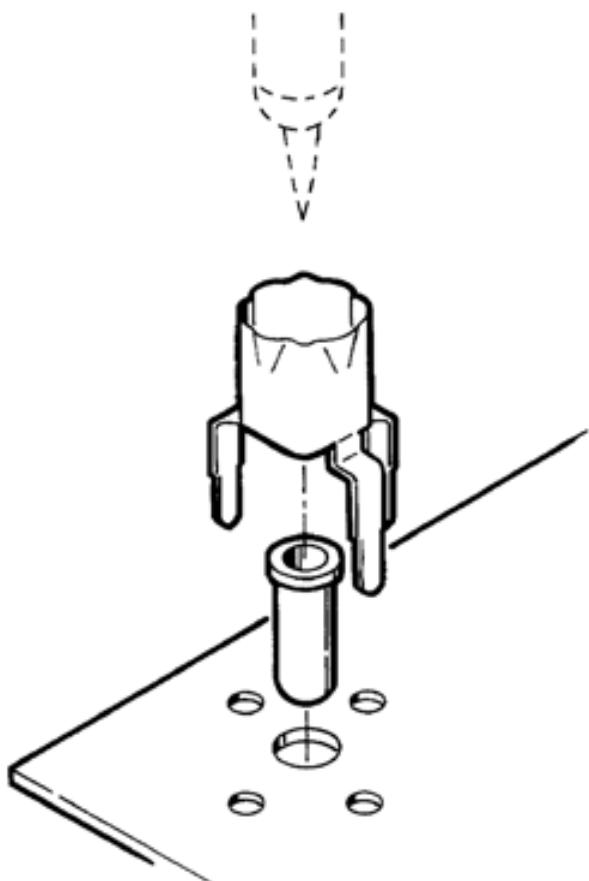
图 4.11. ECB 到探头头部适配器。
