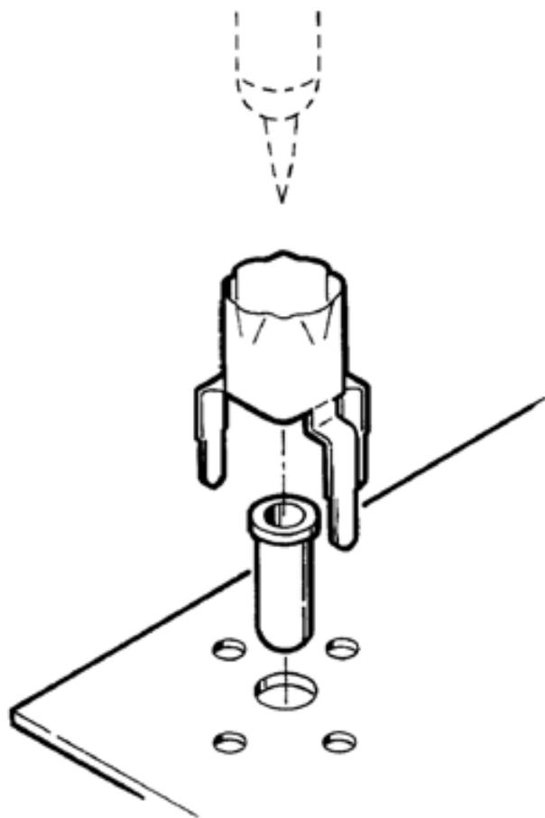
图 6.2. ECB 到探头尖端适配器。
