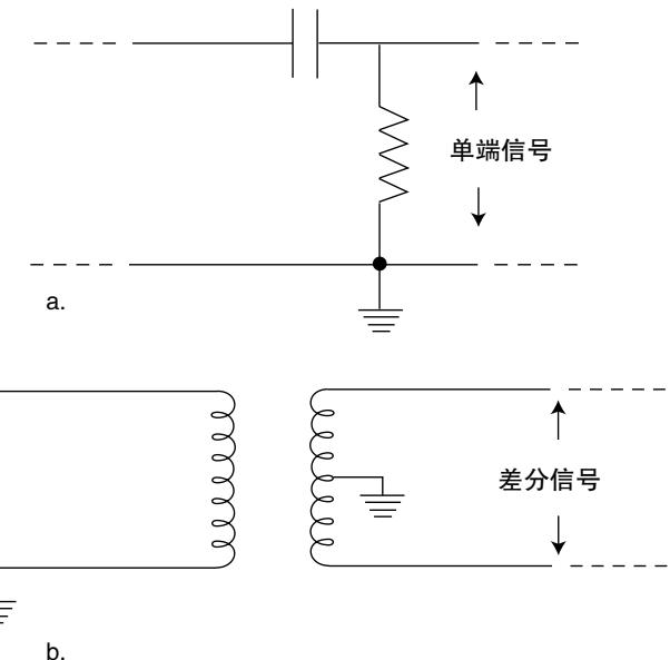
图 2.2. 单端信号参考接地 (a)，而差分信号则是两条信号线或两个测试点之差 (b)。
