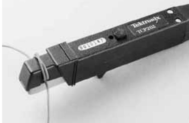
图 2.8. 分芯 AC 电流探头实例。在探头上把导线绕  $n$  圈，可以使有效的灵敏度提高  $n$  倍。
