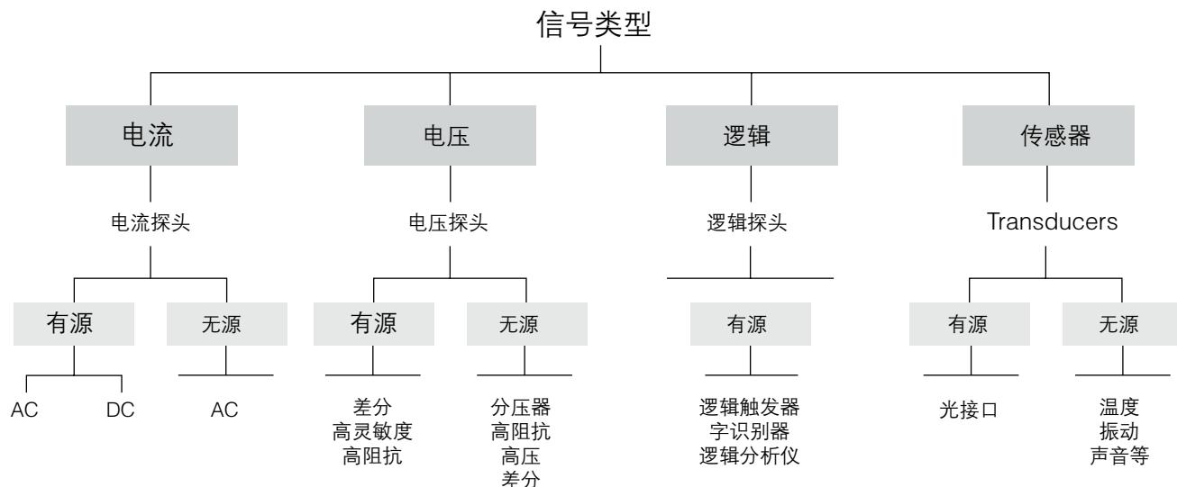
图 3.1. 根据被测信号类型划分的探头种类。
