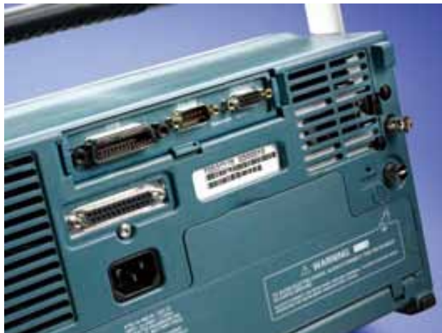
图 53. 当前的示波器提供了广泛的一系列通信接口，如标配 Centronics 端口及选配以太网 /RS-232、GPIB/RS-232 和 VGA/RS-232 模块。其前面板上甚至还有一个 USB 端口 (画面中没有显示)。
