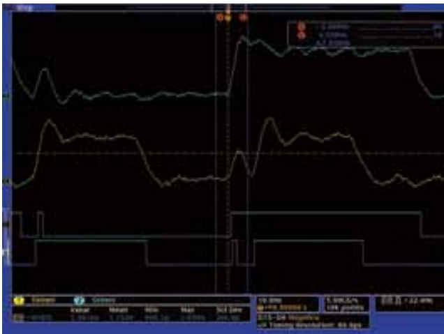
图 52. MSO 提供了 16 条集成数字通道，可以观察和分析时间相关的模拟信号和数字信号。高速定时采集提供了更高的分辨率，可以揭示毛刺之类的窄事件。
