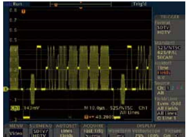
图 58. 视频应用模块使得示波器成为快速的、揭示一切细节的视频调试工具。
