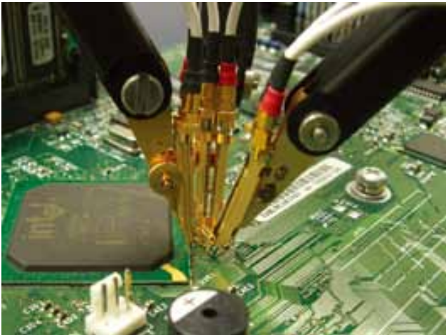
图 41. 在测量当前计算机总线和数据传输线中的快速时钟和边沿时，高性能探头至关重要。
