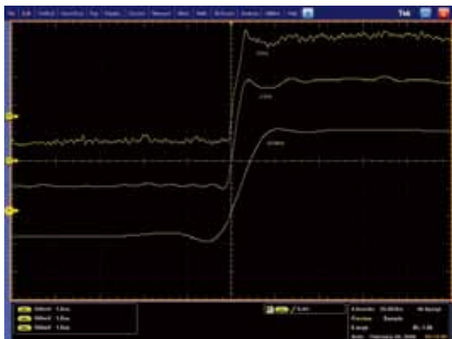
图 45. 带宽越高，信号复现精度越高。如图所示，这是 250 MHz、1 GHz 和 4 GHz 三种带宽水平下捕获的信号。
