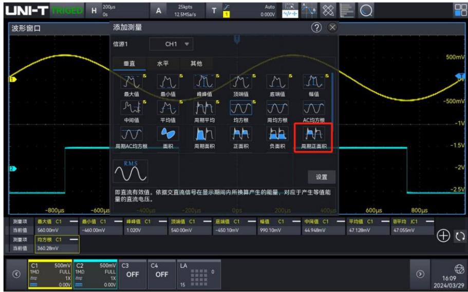
图3 波形半波的电压时间一积分测量功能
