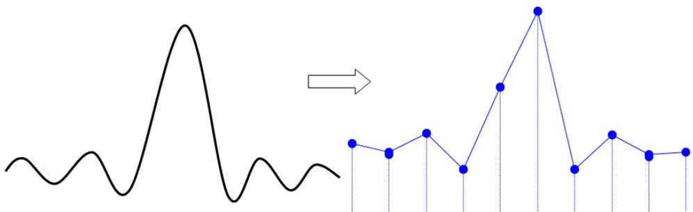
波形混叠：由于采样率低于实际信号频率的 2 倍（Nyquist Frequency，奈奎斯特频率），对采样数据进行重建时的波形频率小于实际信号的频率。
