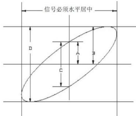
根据  $\sin\theta=A/B$  或  $C/D$ ，其中 $\theta$ 为通道间的相差角，A、B、C、D 的定义见上图，因此可得出相差角即 $\theta = \pm \arcsin(A/B)$  或者  $\theta = \pm \arcsin(C/D)$ ，如果椭圆的主轴在 I、III 象限内，那么所求得的角度应在 I、IV 象限内，即在  $(0 \sim \pi/2)$  或  $(3\pi/2 \sim 2\pi)$  内。如果椭圆的主轴在 II、IV 象限内，那么所求得的角度应在  $(\pi/2 \sim \pi)$  或  $(\pi \sim 3\pi/2)$  内。
