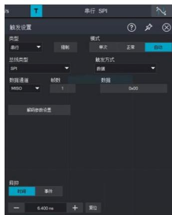
(4) 解码参数设置：触发解码参数设置将与协议解码参数设置同步。请参考协议解码章节的“[SPI](#)”一节。
