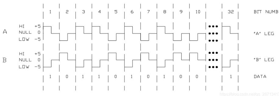
在协议层, 一个数据包传输 32bit 数据, 先传输低位再传输高位
