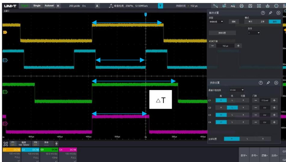
**码型设置：** 点击参数设置弹出设置弹窗，码型设置支持选择 H, L, X, 门限表示判定 H, L, X 的电压值。
