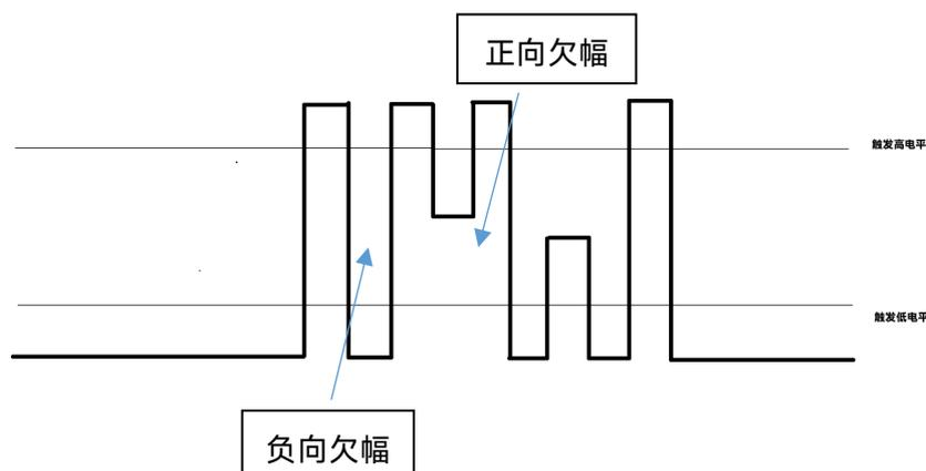
欠幅触发菜单列表可设置：信源、触发耦合、触发模式、触发极性（正、负）、欠幅条件（无关、<、>、[...]）、触发低电平、触发高电平、脉冲宽度上限、脉冲宽度下限等。
