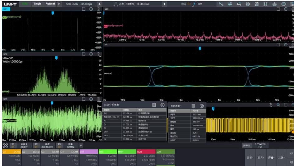
TIE（时间间隔误差）为信号相对于参考时钟的定时误差，TIE 在高速数字系统中即为抖动，本示波器中的 TIE 指的是  $TIE_{peak-peak}$ 。将被测信号的边沿与时钟恢复确立的理想边沿进行比较，按照理想数据速率测量所有的信号间隔。
