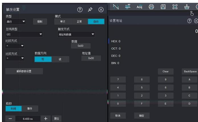
(4) 解码参数设置：触发解码参数设置将与协议解码参数设置同步，请参考协议解码章节的“[I2C](#)”一节。
