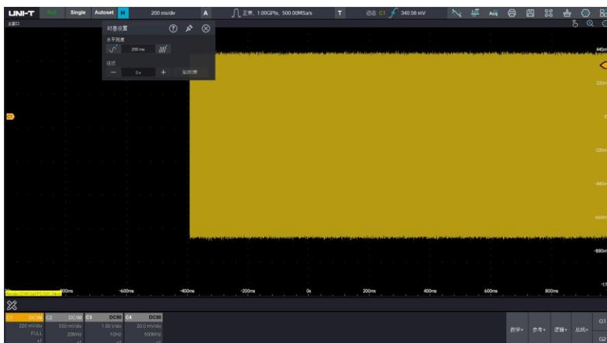
应用 Roll 模式观察低频信号，建议将“通道耦合”方式设置为“直流”。
