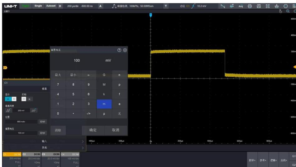
设为0：点击偏置电压旁边设为0标签，将通道偏置电压设置为0mV。
