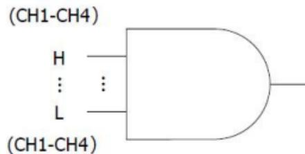
**码型设置：** 码型设置支持选择 H、L、X、上升沿、下降沿。屏幕下方显示每个通道的码型设置。
