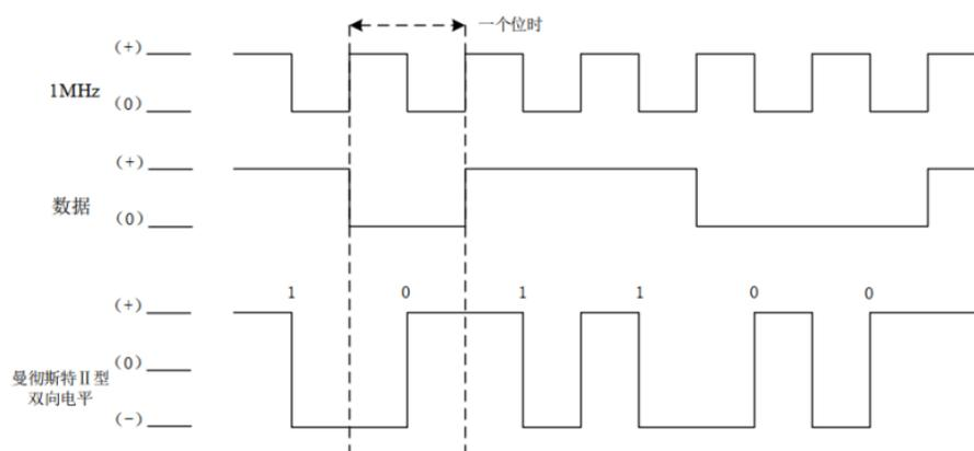
MIL-STD-1553 信息流由一串 1553B 消息构成，1553B 消息由命令字、数据字、状态字组成。1553B 消息的最小单位为位 bit，每 20 位形成一个字，每个字的有效信息位为 16bit，在有效信息位的前面有 3 位的同步头（同步头被分为 2 个一位半），有效信息位的后面有 1 位校验位（采用奇校验）。
