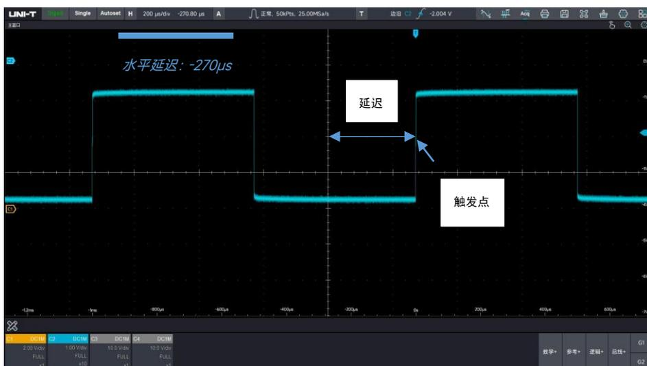
改变水平延迟时，波形将跟随触发点左右移动。
