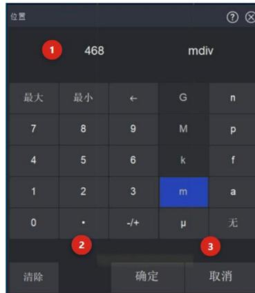
数字键盘采用了传统的 9 键布局方式，用于用户输入数值及单位。数字键盘的单位格式与功能有关，如设置垂直位置，数字键盘打开后默认单位后缀为 div，表示输入的数值量单位为屏幕显示的格数。
