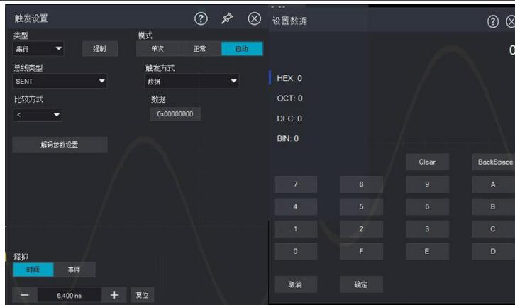
(3) 解码参数设置：触发解码参数设置将与协议解码参数设置同步，请参考协议解码章节的“[SENT](#)”一节。
