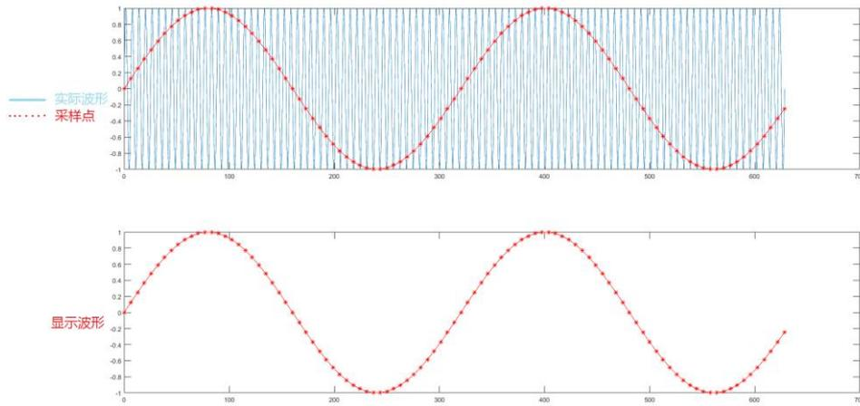
波形漏失：由于采样率过低，对采样数据进行重建时的波形没有反映全部实际信号，如下图所示。
