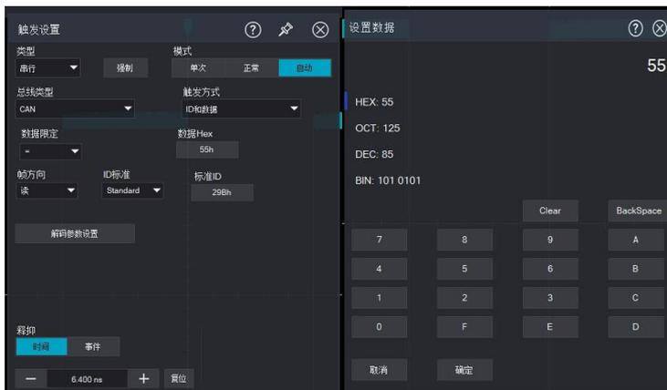
(7) 解码参数设置：触发解码参数设置将与协议解码参数设置同步。请参考协议解码章节的“CAN”一节。
