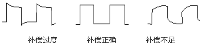
图 4-2 探头补偿校正
