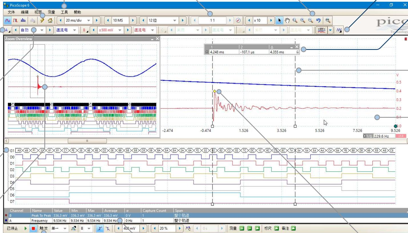
**标尺:**每个轴有两个标尺,可将其拖至屏幕上以快速测量振幅、时间和频率。
