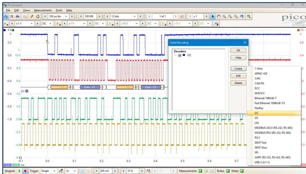
图形格式在公共时间轴上的波形下方, 以计时图表格格式显示解码数据(十六进制、二进制、十进制或 ASCII), 错误帧标记为红色。您可以对这些帧进行放大, 从而查找噪音或失真, 每个数据包都分配了不同的颜色, 因此
