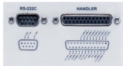
在接口的配置上，LCR-6000 系列提供的 Handler 和 RS-232C 的接口。Handler 的接口提供了 10BIN(9BIN,AUX:1BIN) 的分选结果输出，适用于外部连接控制，例如：连接选别机进行组件的分选作业。而 RS-232C 接口，则适合于远程控制 and 撷取测量结果的使用者，让设定控制或测量结果的读取可透过 PC 传送指令来进行，达到检测自动化应用的需求。
