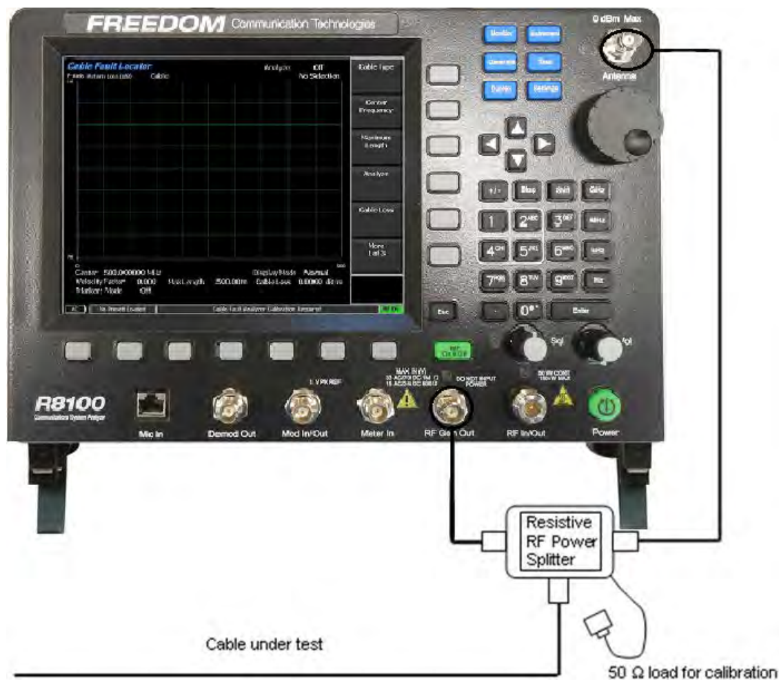
图 5.3-1 电缆故障测试的连接
