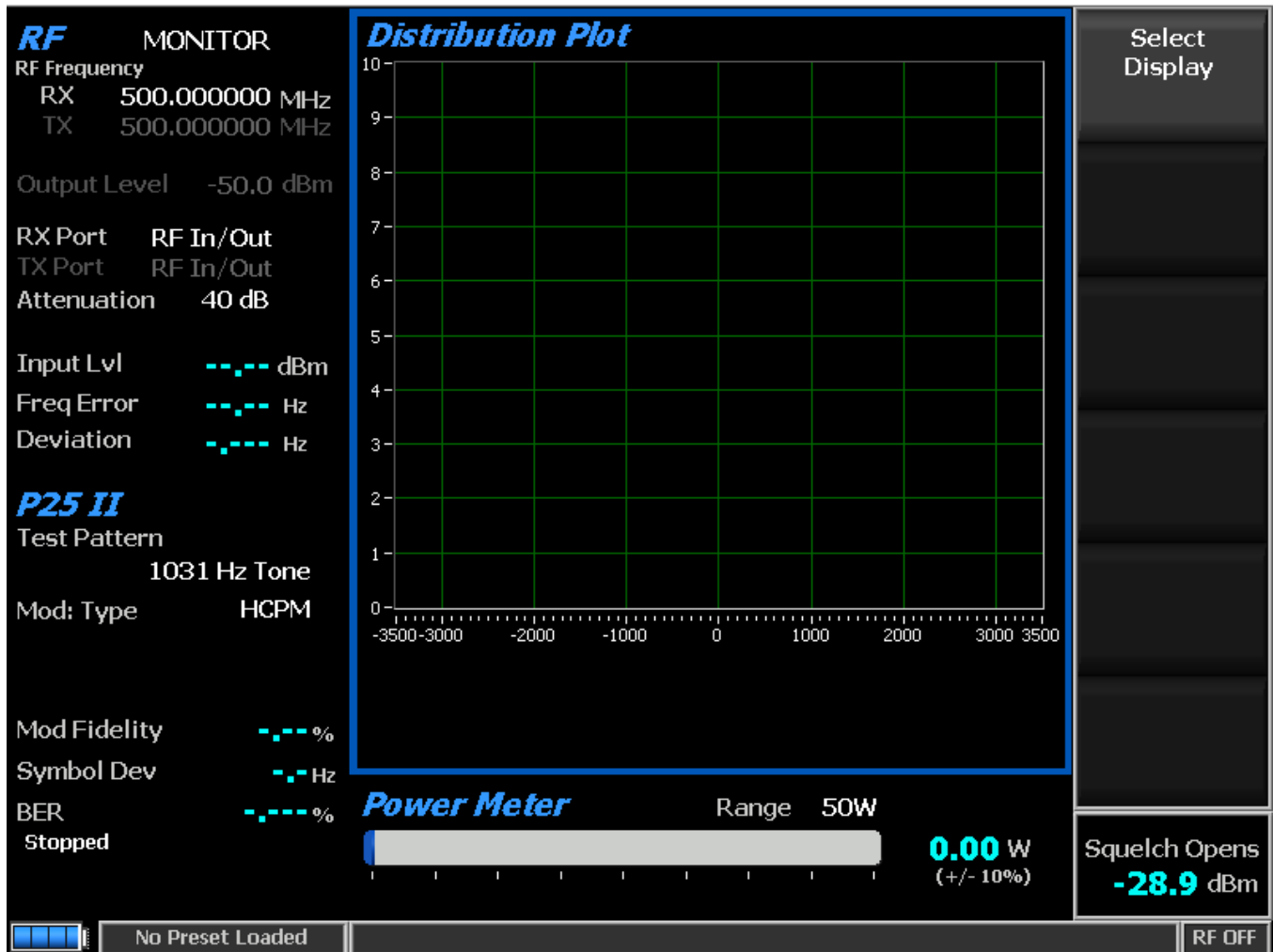
图 2.2.7.9.1-1 选择 P25 II 测试模式后，监视模式下的主屏幕
