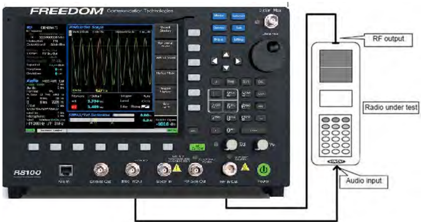
图 5.1.1-1 FM 发射器测试设置
