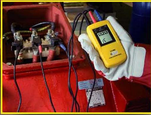
C.A 6608和C.A 6609测试仪是必不可少的设备，用于检测电气装置的相序和连接到该装置的任何工业设备的电机转向。
