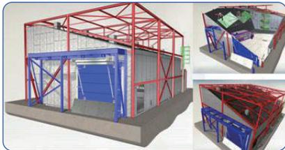
支撑钢框架为自立式钢结构，独立于周边建筑墙体和顶面，其抗地震作用十分重要。支撑钢框架是提高电波暗室抗地震能力的唯一途径。电磁屏蔽壳体（电磁兼容暗室壳体即为电磁屏蔽室）主要作用是屏蔽外部电磁干扰，一般为钢板材料拼接而成。
