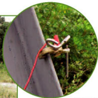
在沿输电线路走向的垂直方向两侧，分别安置辅助电流极 H 及电压极 S（减小输电线路的电磁干扰），距离大于50m。将 Ampflex 柔性电流钳分别安置于待测杆塔的4个塔脚，并连接至C.A6474；C.A6474和C.A6472之间使用专用通讯缆线连接。将C.A6472的“E”和“ES”端子连接至塔身（位于AmpFlex 电流钳上方）；当测量进行时，测试电流导入塔身，经4个塔脚流入其下部的“自然+人工接地体”。通过4个安置于塔脚的Ampflex 柔性电流钳，可采集到流经各塔脚的电流，即可计算出各塔脚的接地电阻值，及杆塔整体的接地电阻值（即4个塔脚接地电阻的并联值）。
