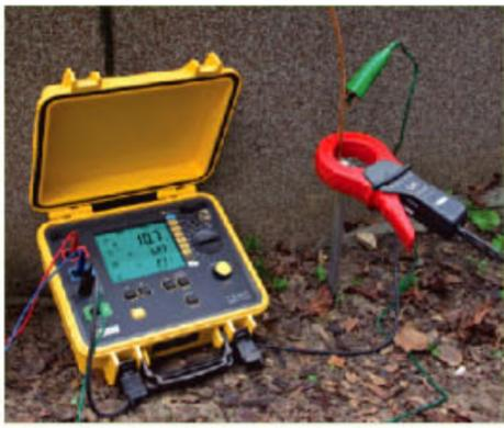
经由选择性四极法测量多点并连接地系统时，从测试原理来看，各个接地极的接地电阻值测量值不受其他并连接地极的并联影响。如要计算接地系统整体性的接地电阻时，则需透过计算来考量所有接地极的并联效应。
