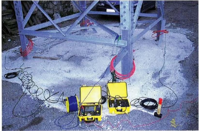
Abb. 2. Selektive Erdungsmessung eines Mastes mittels Rogowski-Spule
