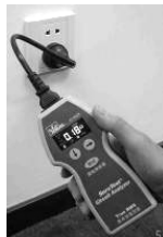
图 2-1 用交流电路分析仪检测电源插座配电方式与 PE 线阻抗
